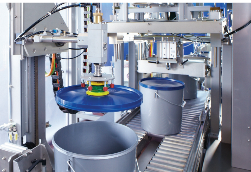
Das Eimer-Handlingsystem sysLAN integriert sowohl das Entstapeln als auch das Verschließen und Etikettieren von Eimern und Deckeln: Entweder in einer Gesamtlinie oder als einzelne Komponenten inklusive Füller und Palettierung.
